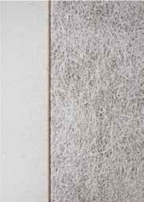
Houtwolcementplaat Plaat opgebouwd uit ecologische en eerlijke materialen: hout, water en magnesiet. Oud materiaal van vroeger wordt weer mooi!
