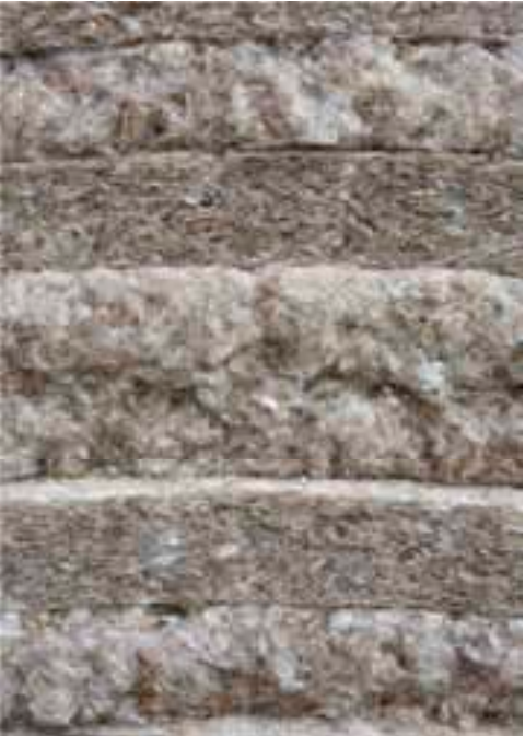
Vlasisolatie Toegepast tbv de akoestiek in de speciaal voor TNT Centre ontworpen systeemwanden.
